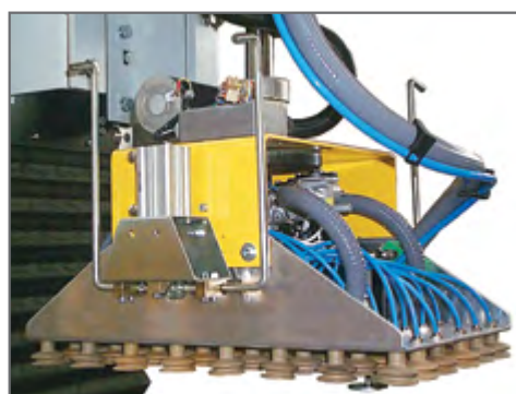
Pinza a ventose con ganci presa pallet integrati
